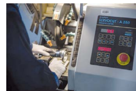
CIĘCIE PRZEGUBU NA PRÓBKĘ PODDAWANĄ BADAANIOM LABORATORYJNYM
