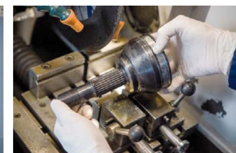
MOCOWANIE PRZEGUBU W IMAKU KOMPUTEROWEJ PRZECINARKI
