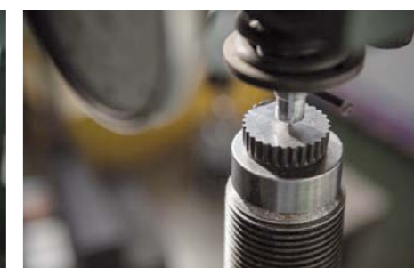
BADANIE TWARDOŚCI METODĄ BRINELLA/VICKERSA NA SPECJALNEJ PRASIE
