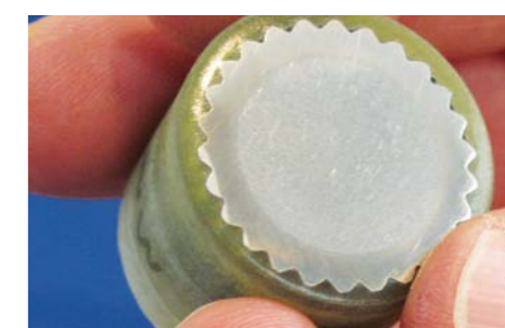
PRÓBKA METALU PO OSADZENIU W SPECJALNEJ ŻYWICY I OSZLIFOWANIU POWIERZCHNI PRZYGOTOWANA DO ANALIZY METALOGRAFICZNEJ
