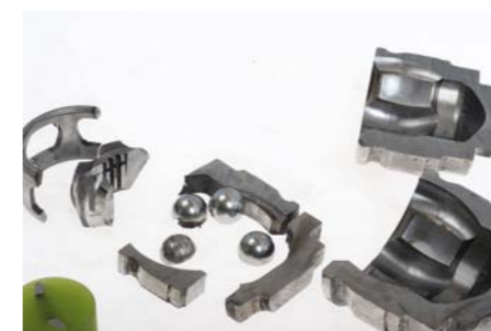
CIĘCIE PRZEGUBU NA PRÓBKĘ PODDAWANĄ BADAANIOM LABORATORYJNYM
